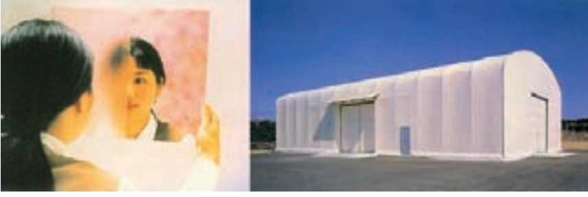
Şekil 6: Buğulanmayan banyo aynası ve açık havada durmasına rağmen kendi kendini temizlediği için kirlenmeyen çadır.
